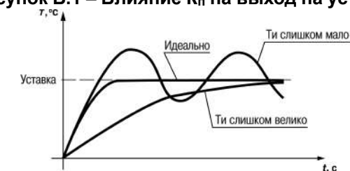
Рисунок Б.2 – Влияние \tau_{\text{И}} на выход на уставку
